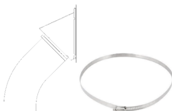
Figura 17 – instalação boca de carga e abraçadeira metálica
