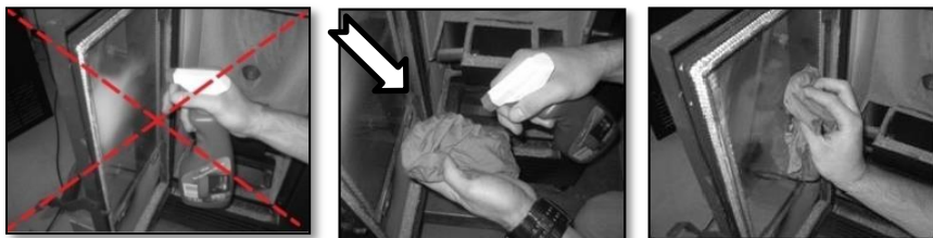
Figura 45 – Exemplificação método de limpeza do vidro
